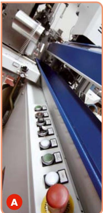
**A** Macchina automatica bifilare Taglia / Spella / Aggraffa con inserimento tre capsule d'isolamento e la possibilità di cablare due cavetti di materiale, sezione e colore diversi.
